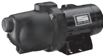
Las bombas tipo jet Serie PN son resistentes a la corrosión y la abrasión debido a su construcción en materiales de alta calidad, son ideales para uso general en sistemas de alta presión y en bombeo de pozos hasta de 25 pies de nivel dinámico. Son autocebantes después de que se llena inicialmente el cuerpo de la bomba. Operación silenciosa. Sus principales materiales y características son:
