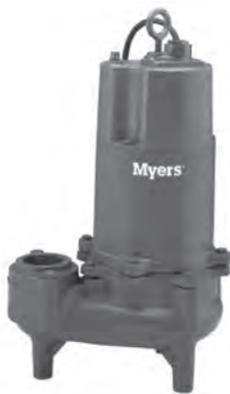
Las motobombas sumergibles para aguas residuales WHR tienen capacidad de manejar hasta 2" de sólidos, su impulsor recesivo tipo vórtex permite el paso por la voluta de sólidos extraños sin que éstos atasquen el impulsor, esto también extiende la vida útil de los baleros del motor. En los modelos monofásicos el capacitor se encuentra en la carcasa superior, lo que permite reemplazarlo sin desmantelar el motor.
