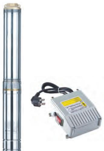
Las bombas sumergibles para pozo profundo ARENKA serie 4FG, están fabricadas en acero inoxidable AISI 304, para pozos de 4", diseñadas para entregar caudales que van desde los 15 GPM hasta los 50 GPM y cargas de hasta 270 ft, son ideales para aplicaciones residenciales, comerciales, industriales y agrícolas. Tienen las siguientes características:
