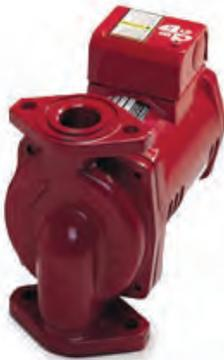
Las recirculadoras de agua caliente libres de mantenimiento serie PL de Bell & Gossett son bombas específicamente diseñadas para un funcionamiento silencioso en sistemas de calefacción y refrigeración hidrónicos, radiantes y geotérmicos. Estas bombas tipo “in line” con lubricación permanente (rotor húmedo) están construidas en hierro fundido. Sus principales materiales y características son:
