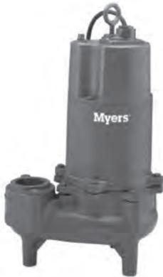
Las bombas sumergibles serie WHR-H de Myers® son bombas resistentes, construidas en hierro fundido para aplicaciones de cárcamos de aguas residuales residenciales y comercial ligeras, donde se requieren cargas superiores a las habituales. Están diseñadas con un impulsor tipo vortéx, el cual le permite un paso de sólidos de hasta 2", y un mejor manejo de basura fibrosas, evitando el atascamiento del equipo.
