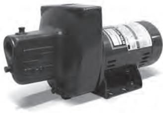
Las bombas centrífugas autocebantes inyectoras en hierro Serie SN ofrecen un excelente funcionamiento, ideal para sistemas de alta presión, para pozos de hasta 25 pies de profundidad y en aplicaciones generales, riego, etc. Están construidas con materiales de la más alta calidad tanto en la parte hidráulica como en el motor. Incluyen switch de presión preajustado a 30-50 psi. Sus principales materiales y características son:
