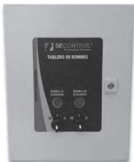
Los tableros SECONTROL® para vaciado de cárcamos controlan la operación de 1 a 3 bombas según las señales de las peras de nivel (flotadores) instalados en el interior del cárcamo. En los modelos de 2 a 3 bombas alternan y simultanean los equipos.
