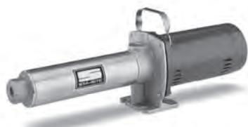
Las bombas tipo Booster HP y HPS están diseñadas para tener una larga durabilidad. Su sistema patentado de impulsores flotantes minimiza las cargas axiales permitiendo una operación continua sin daño a los baleros, el sello mecánico y los componentes hidráulicos. Tiene su aplicación en lavado de autos, filtración y ósmosis inversa, sistemas de alta presión, HVAC y usos generales. Sus principales materiales y características son:
