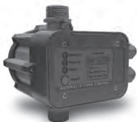
El control automático de presión AQTPS1 permite operar una bomba monofásica 115V de hasta 10 A, permitiéndole arrancar cuando hay demanda de caudal y parar cuando no se tienen demanda del mismo, su mecanismo le permite operar confiablemente manteniendo la presión constante y cuenta con una protección para no operar la bomba en seco. Ideal para controlar bombas centrífugas e inyectoras en instalaciones domésticas. Sus principales características son:
