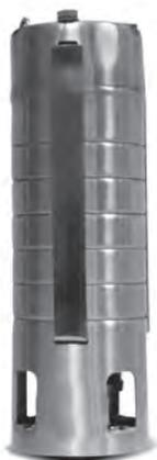
Las bombas sumergibles Shakti para pozo profundo están fabricadas en acero inoxidable 304, para ademes de 4", diseñadas con una amplia gama de modelos y tamaños, diseñados para entregar caudales que van desde los 10 GPM hasta los 80 GPM y cargas de hasta 1,100 ft. Construidas para aplicaciones residenciales, comerciales, industriales, y agrícolas donde el agua es limpia y sin sólidos en suspensión.
