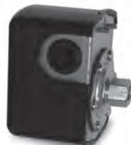
Los presostatos Aquex® funcionan mediante un par de platinos que se cierran o abren dependiendo de la presión alcanzada por el sistema que están censando, mediante la acción de un par de resorte de calibración, protegidos a través de una cubierta plástica que le permite estar a la intemperie.
