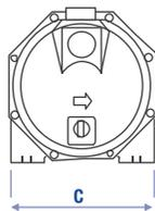
Bomba tipo jet con excelente capacidad de autocebado. (Válvula de pie o retención requerida) construida en hierro fundido.
