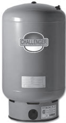
Los Tanques precargados Challenger® con tecnología de diafragma CAD2, están contruidos en acero solido calibre 16. Diseñado pensando en las necesidades de los contratistas con calidad Flexcon y rendimiento a un precio competitivo. Cada tanque se somete a pruebas de costura, alta presión y helio, para detectar fugas de aire. Una prueba final de aire asegura que cada tanque llegue con una pre-carga correcta. Sus principales materiales y características son:
